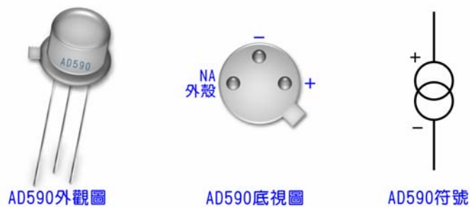
圖23 AD590 之外觀、底部接腳圖與符號
